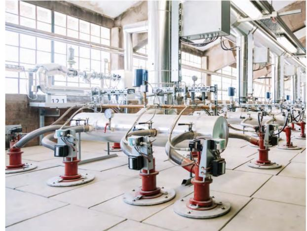
Abbildung 32: Brenner auf einem Tunnelofen;
