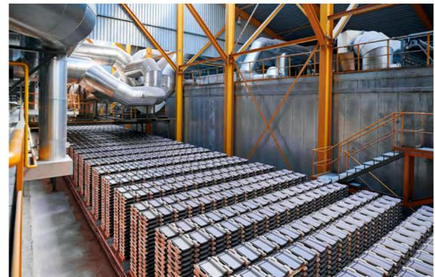
Abbildung 23: Ofenstrecke für Dachziegelproduktion;
