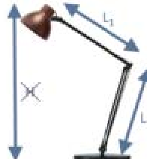
Leuchte (mit Gelenken) Äußere Abmessung: Der größere Wert von L_1 oder L_2 (nicht H)
