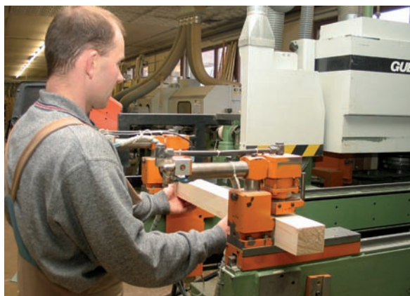
Zuschnitt von Fensterholz, im Hintergrund die Absauganlage
