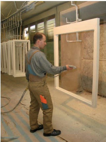
Herr Ettinger lackiert die Fenster mit lösemittelfreiem Lack auf Wasserbasis
