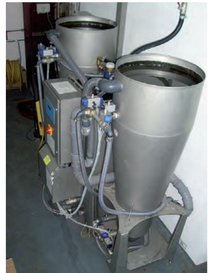
Wasseraufbereitungsanlage für die Autowäsche
