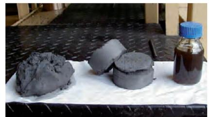
von links nach rechts: Schleifschlamm, Briketts, hochwertiges Schleiföl (recycelt)
